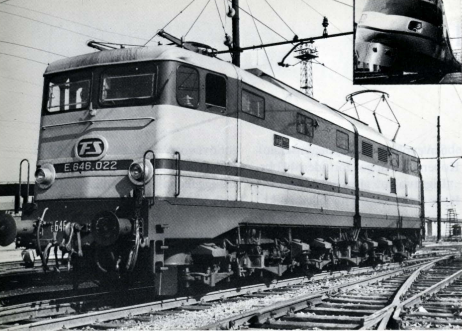
Italienske statsbaners (FS) konventionelle el-loko, E 646, videreudvikles i 1980'erne. El-trækraft vil dominere, men »opgør« kan ventes imellem konventionelt design og »hældeprincippet« som i »Pendolino«-toget (indsat, øverst th.).
